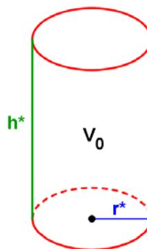
Dans la première partie, nous avons montré que la croquette cylindrique de rayon " $r^* = \sqrt[3]{\frac{V_0}{2\pi}}$ " et de hauteur " $h^* = \sqrt[3]{\frac{4V_0}{\pi}}$ " est la croquette cylindrique de surface minimale.
